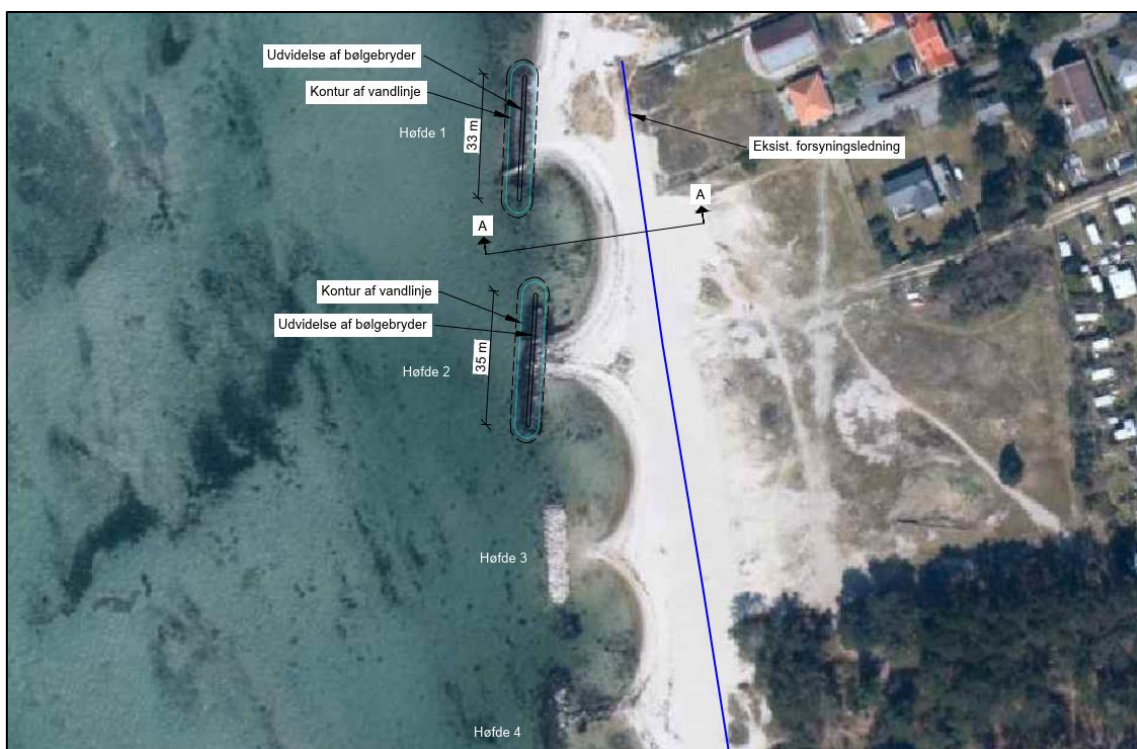
Figur 1. Principskitse over lokalisering af de to bølgebrydere.
